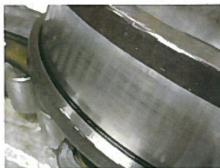
健全な軸受内輪表面
