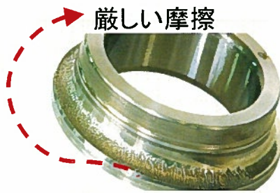
軸受表面に厳しい摩擦で発生した疲労剥離（フレーキング）
