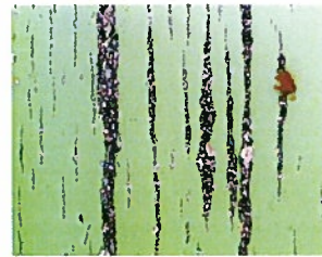
健全な潤滑状態で発生した小さな摩耗粒子（5 \mu\text{m} 以下）
