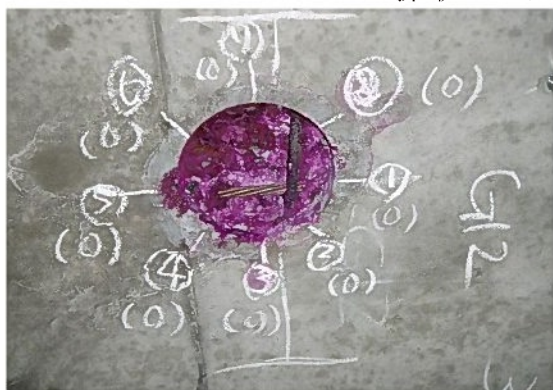
採取コンクリートコアによる中性化試験
